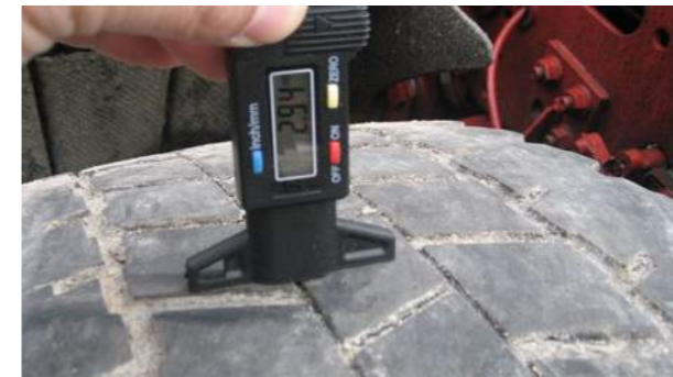
Pneumatici: Urez > 3 mm dubine, uklanjanje
