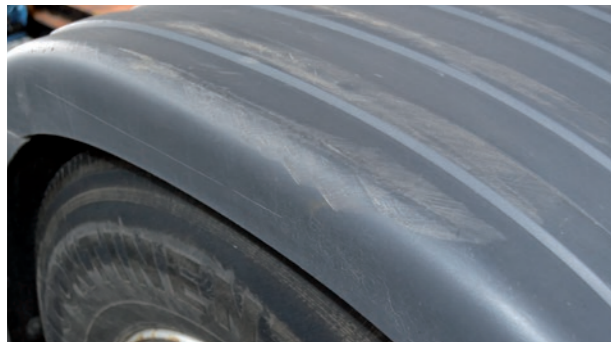
Blage površinske ogrebotine
