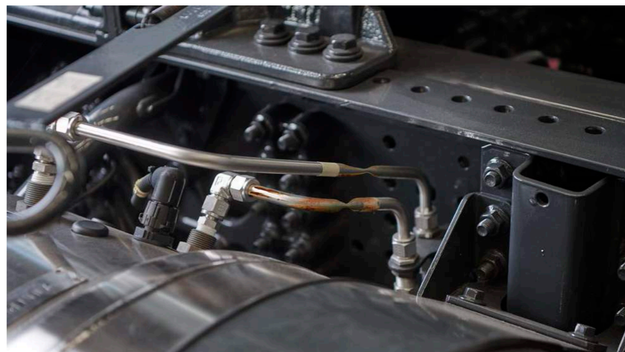
Rđa, ulegnuća, lomovi, udubljenja → naplaćivanje zamene krutih vodova.
