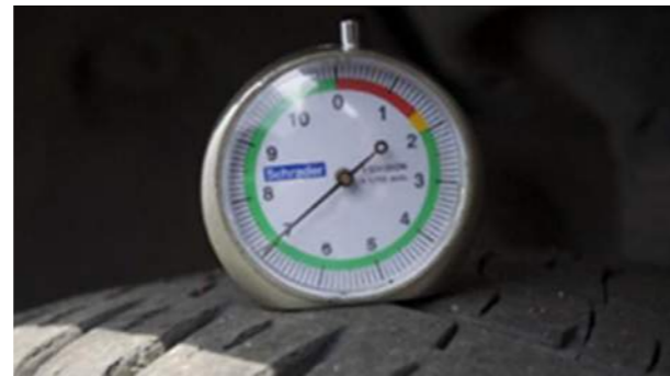
Pneumatici: Osnova dubine žleba \geq 7 mm (USAGLAŠENO)
