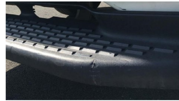
🔧 Zadnje platforme stepenika: Deformacije u okviru ekonomične popravke
