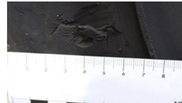
Pneumatici: Urez > 3 mm dubine, uklanjanje
