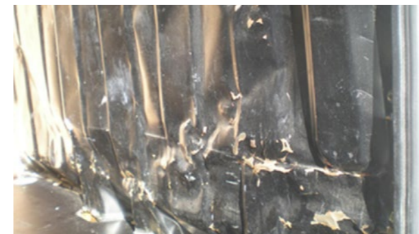
🔄 Unutrašnje deformacije: Znatna deformacija, vreme popravke > 3 h, perforacije, razrezi
