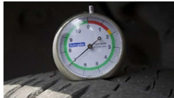
Pneumatici: Osnova dubljine žleba \geq 5 mm (USAGLAŠENO)
