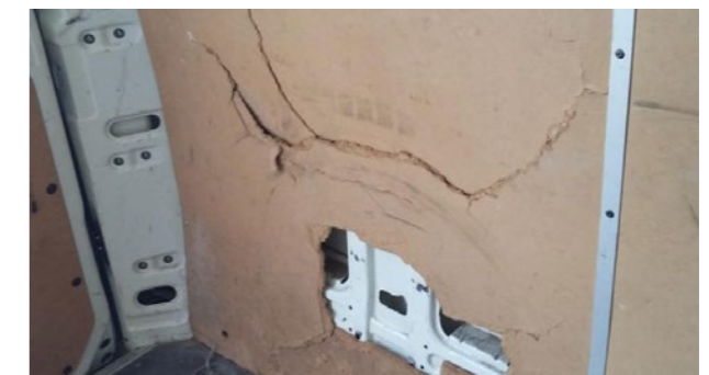
🔄 Drvena unutrašnja zaštita: Udari, rascepan panel, panel nedostaje (ne uključujući gornje panele vrata)
