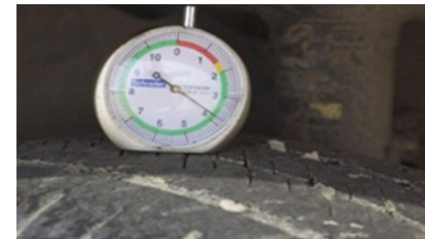
Pneumatici: Osnova dubine žleba < 5 mm Napomena: Pohabanost pneumatika se meri na najviše pohabanom žlebu pneumatika.
