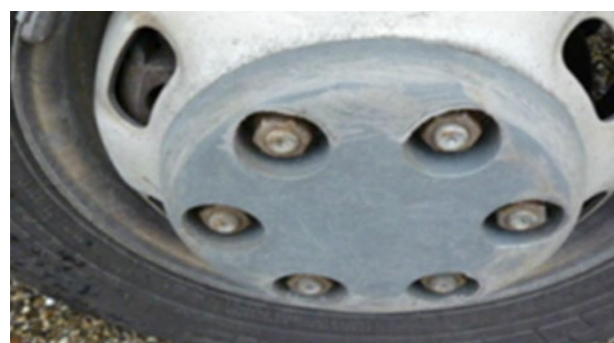
Naplaci i felne: Više površinskih ogrebotina sa ili bez uklanjanja materijala
