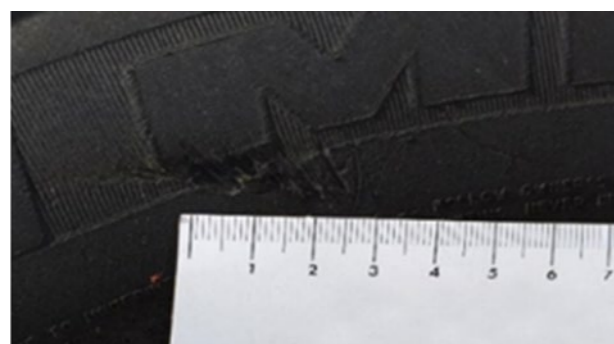
Pneumatici: Urezi \leq 3 mm dubine (USAGLAŠENO)
