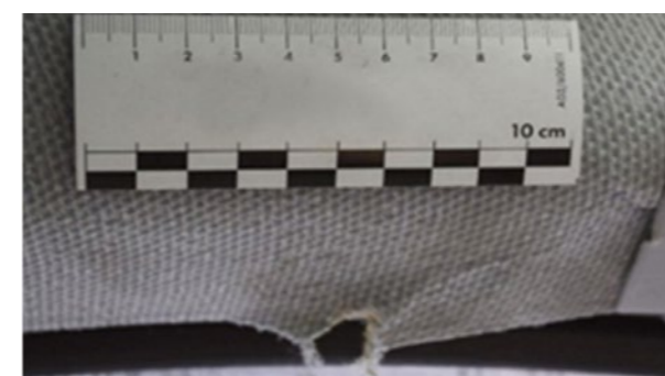
Fabrička obloga: Rascep, otvor > 5 mm, neizbrisivi tragovi
