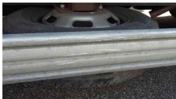
Nosači za bicikle: Bleda ogrebotina
