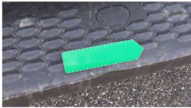
📅 Zadnje platforme stepenika: Blaga deformacija
