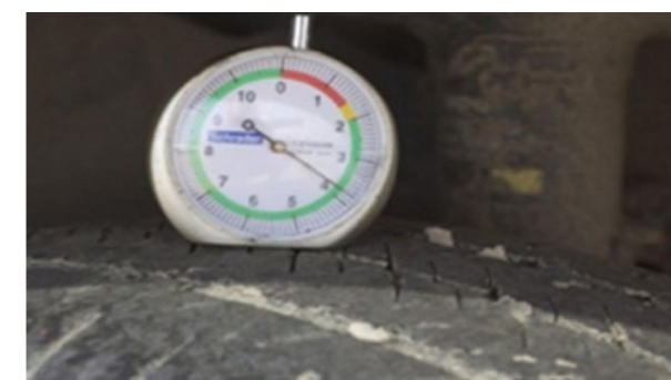
Pneumatici: Osnova dubine žleba < 5 mm Napomena: Pohabanost pneumatika se meri na najviše pohabanom žlebu pneumatika.
