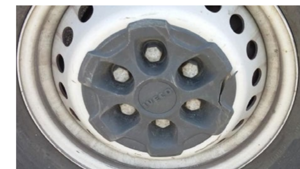
Felne: Deformisane, slomljene, materijal nedostaje ili je uklonjen
