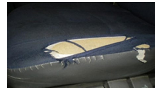
Opekotina > 3 mm, perforacija ili rascep na poklopcu, bez propadanja pene
